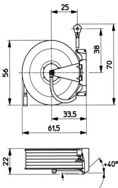
Dévidoir avec fixation murale, pivotant sur 180°, disques de dévidoir en aluminium Ø 56cm, profondeur 22cm avec tambour en plastique, tuyau noir Ø 19/27mm, connexion pour le tuyau de raccordement 1" filetage intérieur, lance à jet creux PICCOJET avec embout intégré. Pouvant être enroulé à gauche et à droite, pouvant être monté à gauche ou à droite.
