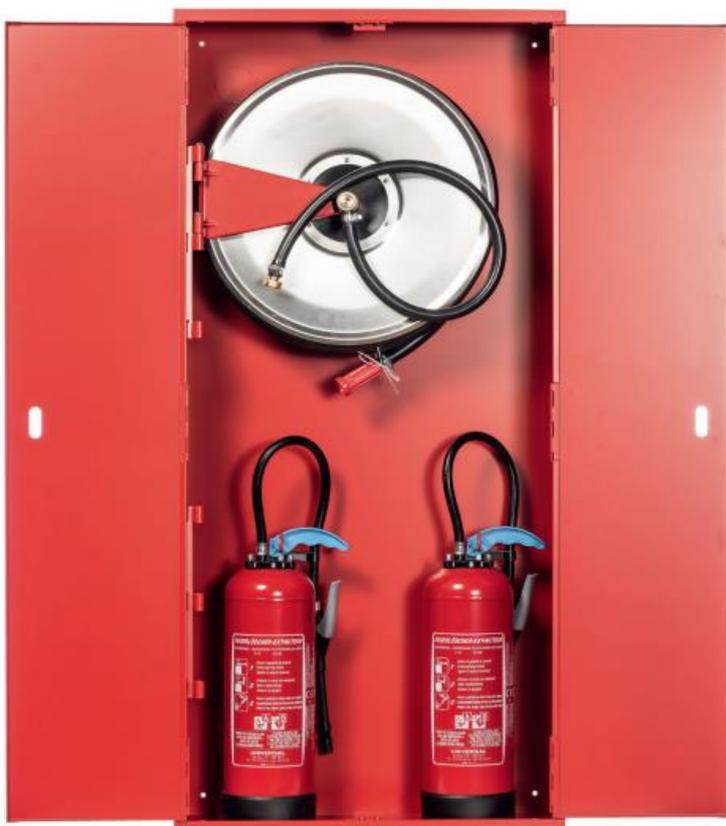
Boîtier en tôle d'acier, gris (NCSS2502B) ou rouge (RAL3000 rouge feu) revêtement poudré, 2 portes, place pour deux extincteurs sous le dévidoir. Disques de dévidoir en aluminium Ø 56cm, profondeur 22cm avec tambour en plastique, tuyau noir Ø 19/27mm, connexion pour le tuyau de raccordement 1" filetage intérieur, lance à jet creux PICCOJET avec embout intégré, prix sans vanne d'incendie.
